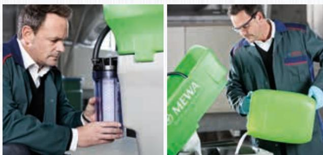
Un service pratique : le système de prestation MEWA inclut l'appoint régulier du liquide de nettoyage, le remplacement des filtres, ainsi que la maintenance de la fontaine.
