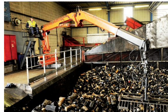
Traitement des filtres à huile
